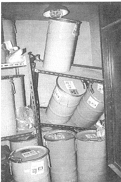
保管庫内の棚破損（旧5号館）
