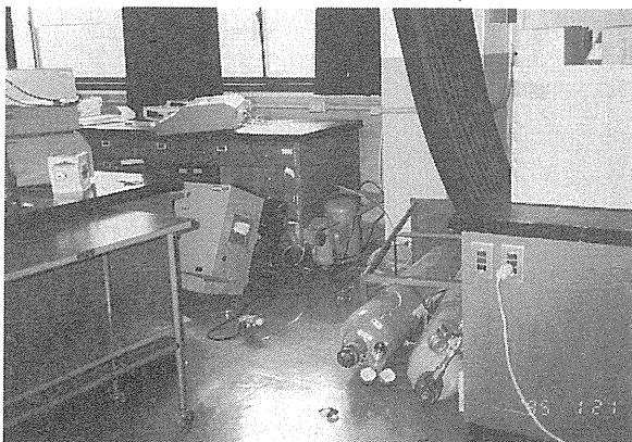
機器やポンペが落下、転倒した実習・測定室内（1号館5階）
